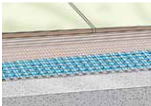
Läggning av klinker och granitkeramik på nygjutet betonggolv.
